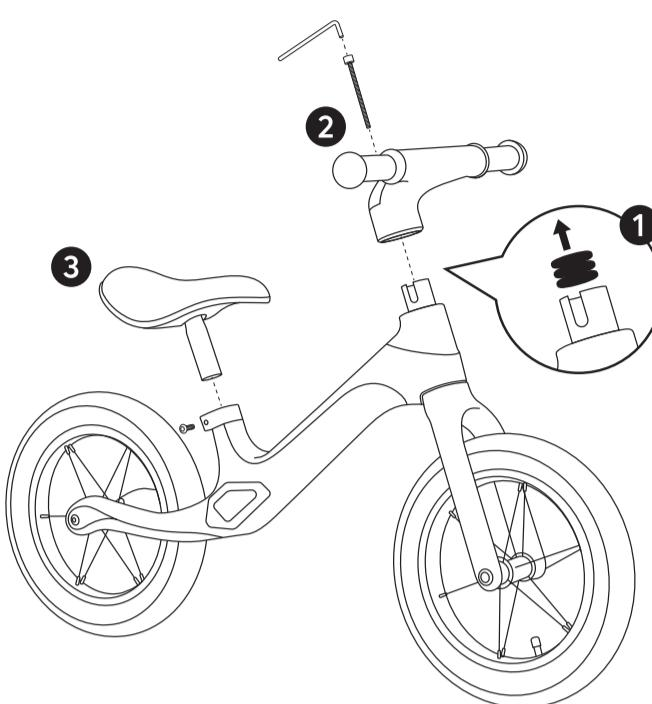
1 Извлеките пластиковую пломбу из рулевой трубы.
